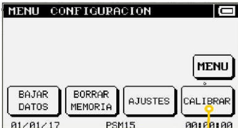
Oprimiendo la tecla **CALIBRAR**, mediante clave alfanumérica de 6 dígitos, se accede a los parámetros de calibración de pesaje .
