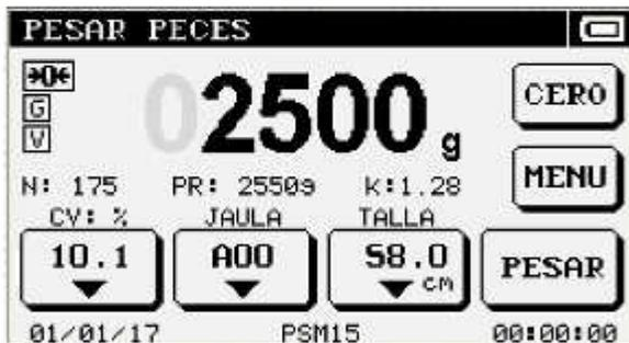
Una vez que se oprime la tecla PESAR, se calculan los coeficientes, suena el Beep en forma intermitente hasta que de haya descargado la balanza por debajo del porcentaje programado, y en ese caso se guardan en memoria los datos registrados en el momento en que la tecla PESAR se oprimió por ultima vez.-
