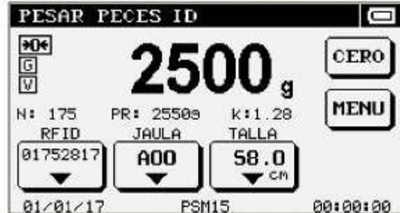
En presencia de un peso Válido, se enciende el indicador [V]. Si se ha seleccionado el modo de pesaje Automático, CON ingreso Manual o Automático de TALLA, este valor de peso se congela en el visor, ni bien se ha confirmada la TALLA se calculan los coeficientes, los datos se guardan automáticamente en memoria, se enciende el indicador [G] y suena el Beep en forma intermitente hasta que de haya descargado la balanza por debajo del porcentaje programado.
