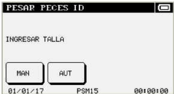
Seguidamente , se debe elegir si el registro del pesaje en la memoria del equipo, se realizara en forma manual o automática, seleccionando con las teclas MAN / AUT
