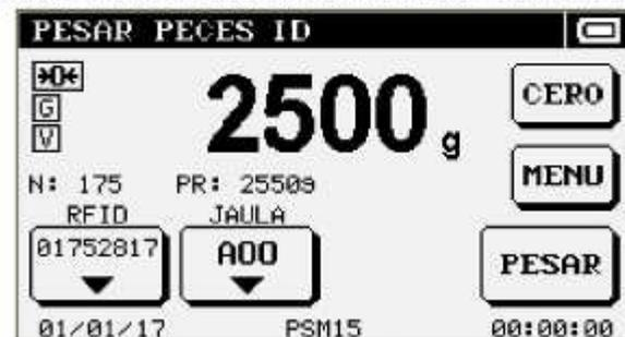
En presencia de un peso Válido, se enciende el indicador [V]. Si se ha seleccionado pesaje Manual, SIN ingreso de TALLA, comenzara a parpadear la tecla PESAR. Una vez que se oprime la tecla PESAR, suena el Beep en forma intermitente hasta que de haya descargado la balanza por debajo del porcentaje programado, y en ese caso se guarda en memoria el peso registrado en el momento que la tecla PESAR se oprió por ultima vez.
