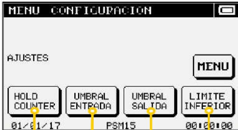
El modo de Pesaje Automático, necesita de la combinación de tres parámetros configurables para determinar la condición de PESO VALIDO (Hold Counter, Umbral de Entrada y Limite Inferior) y un cuarto parámetro para confirmar las acciones de salida (Umbral de Salida).
