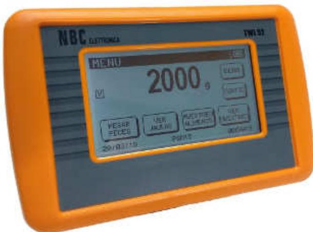
El colector de datos TWI52 es un instrumento construido para trabajar a la intempérie. Tiene un display retroiluminado de buena visibilidad, y un panel tãctil de tipo resistivo que permite trabajar con guantes, o expuesto a gotas de agua.
