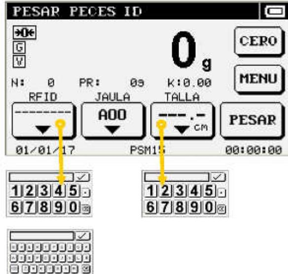
Una vez ingresada la TALLA y en presencia de un peso válido sobre el receptor de carga, comenzará a parpadear la tecla PESAR.
