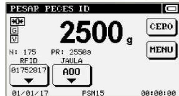
En presencia de un peso Válido, se enciende el indicador [V]. Si se ha seleccionado el modo de pesaje Automático, SIN ingreso de TALLA, este valor de peso se congela en el visor, se guarda automáticamente en memoria, se enciende el indicador [G] y suena el Beep en forma intermitente hasta que se haya descargado la balanza por debajo del porcentaje programado.
